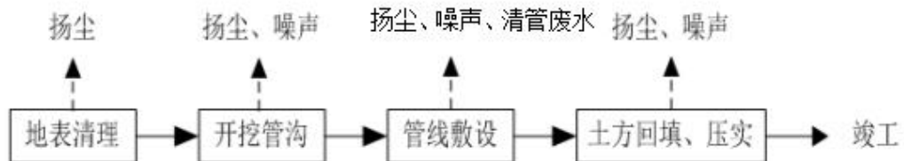
图 4-4 管线建设施工产污节点图
