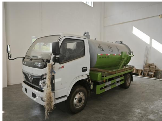
封闭污水罐车
